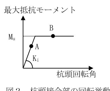
図 2 杭頭接合部の回転挙動
